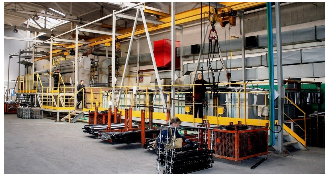
Собственный участок горячего цинкования (толщина покрытия от 40 до 200 мкм)
