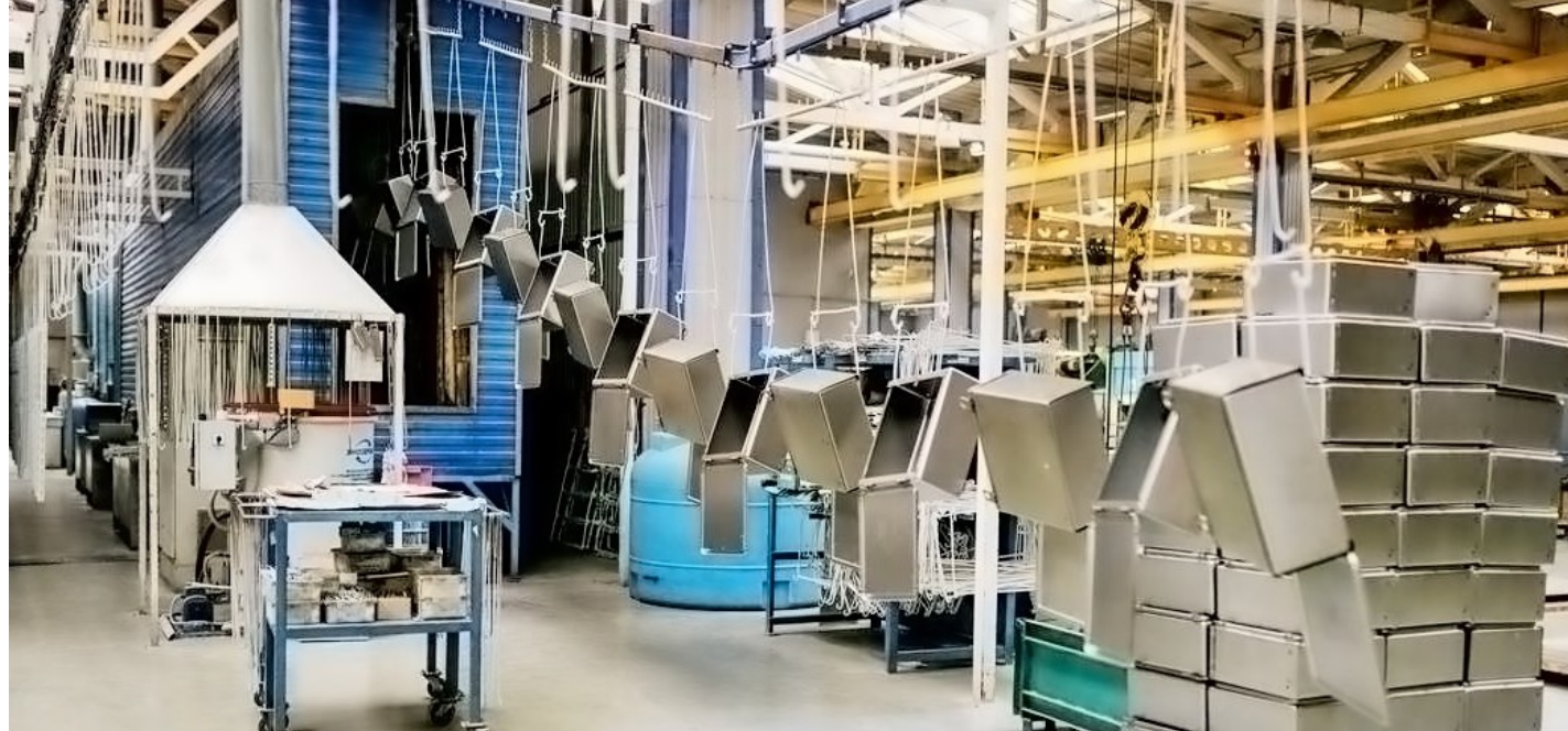
Автоматизированная линия полимерного порошкового покрытия (80–100 м 2 /час)
